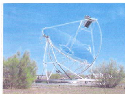
Dish/Stirling Versuchsanlage am europäischen Testzentrum Plataforma Solar de
