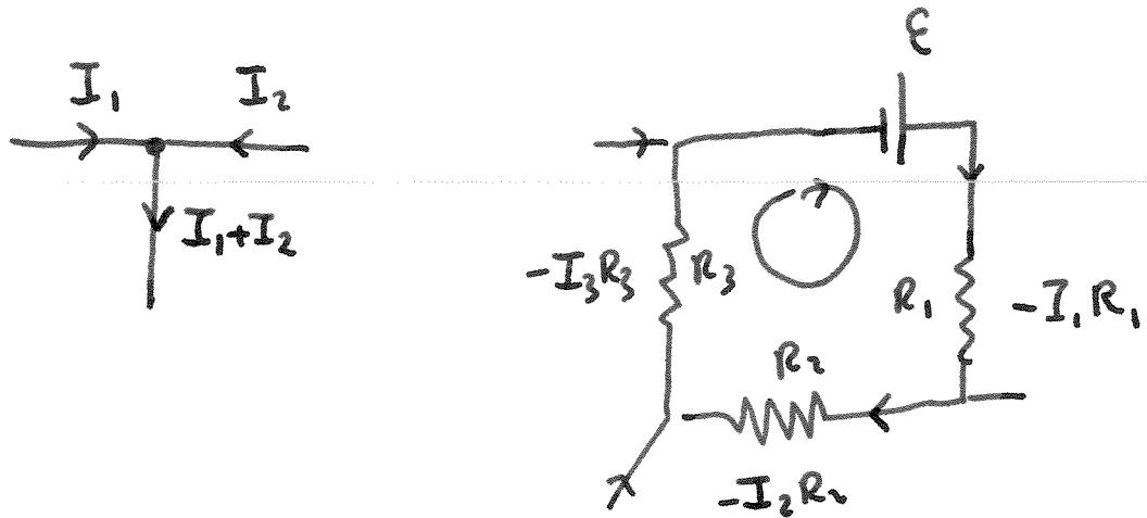
$$\epsilon - I_1 R_1 - I_2 R_2 - I_3 R_3 = 0$$
